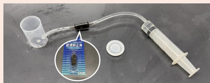
図2. 水蒸気噴火の実験装置本体
