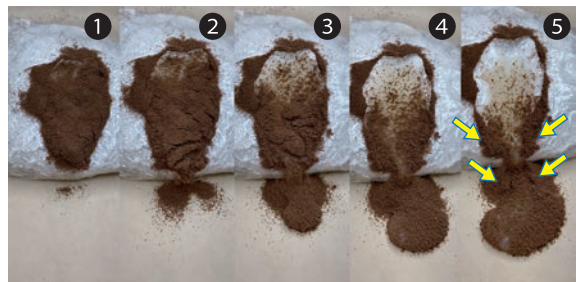
実験の様子。矢印のところに溶岩堤防ができていのがわかります。
