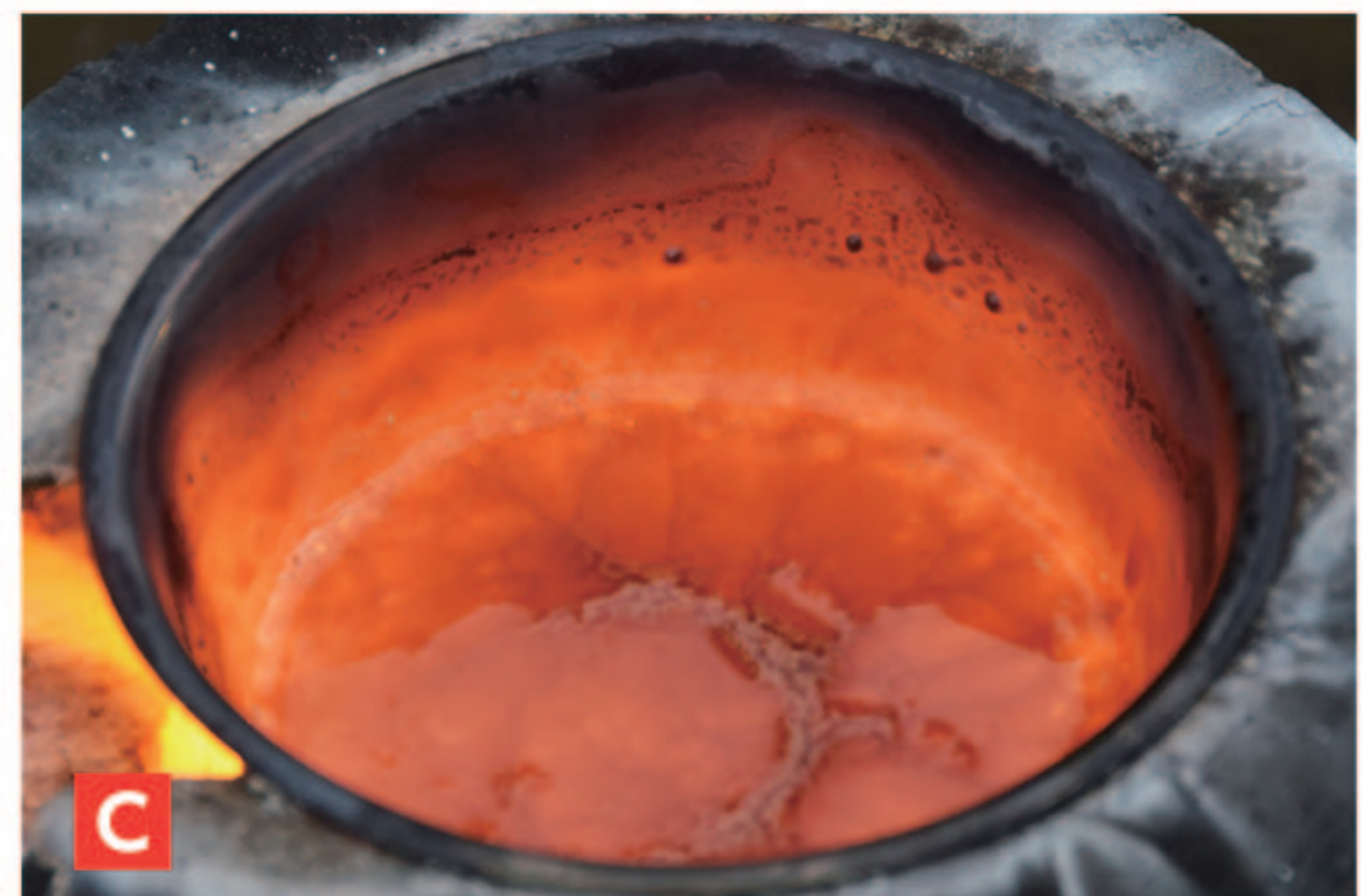
実験のようす。真っ赤な溶岩がステンレス製容器の中で対流するようすが観察できます。
