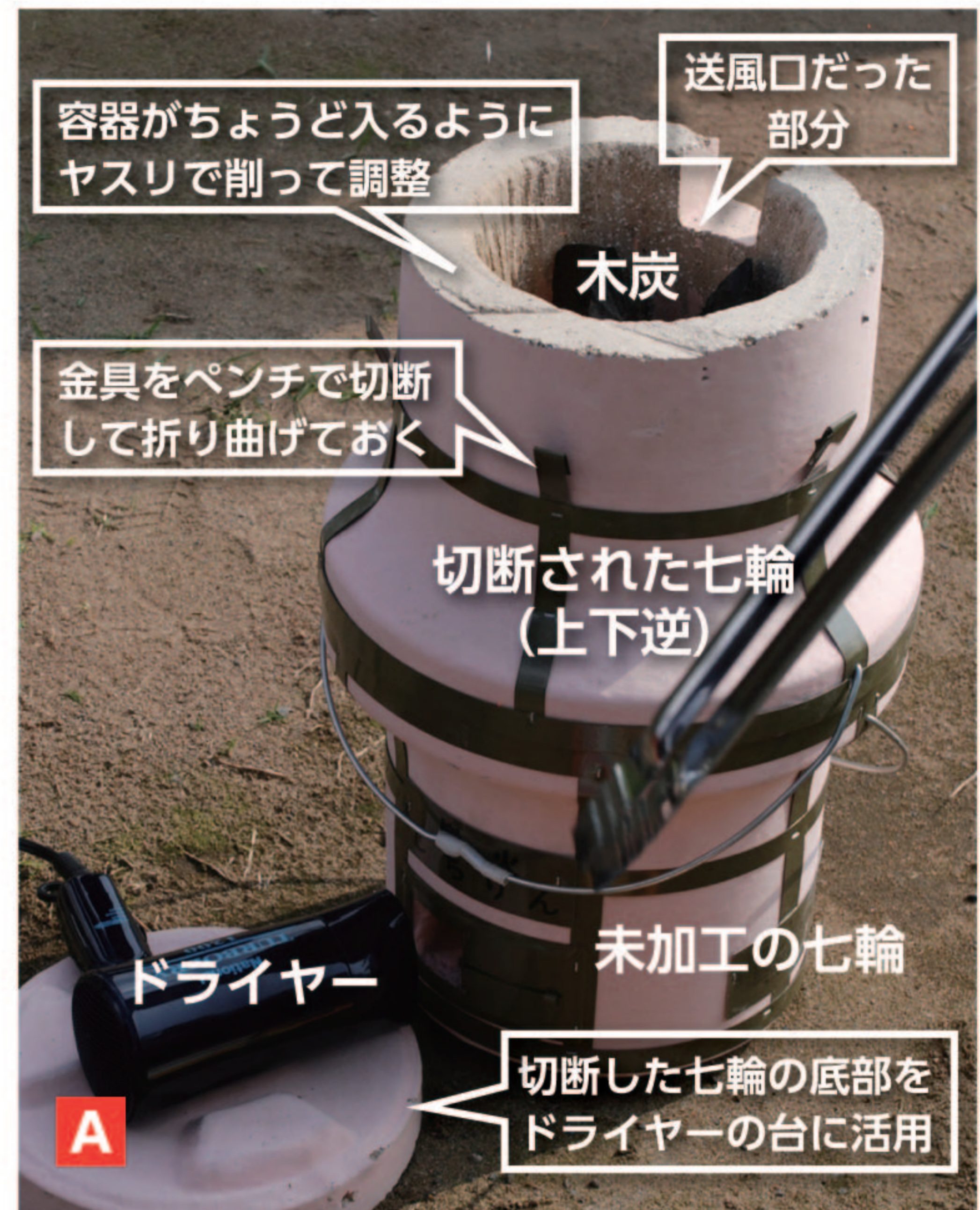
2つの七輪を組み合わせて作った実験装置。切り落とした七輪の底は送風機の台として使えます。
